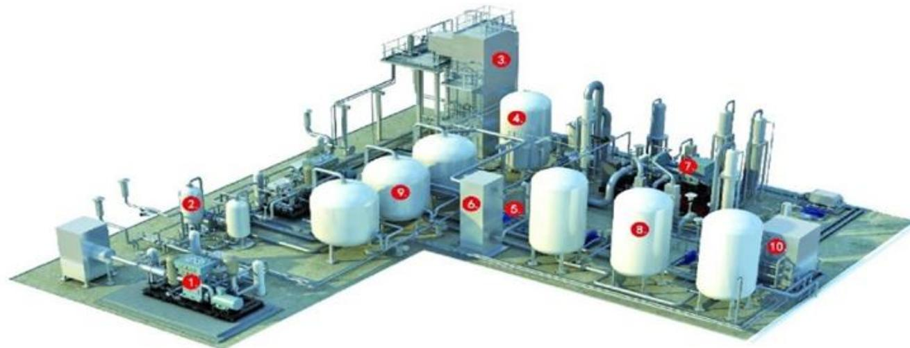
注：1、压缩机组；2、空气净化装置；3、液化装置及制冷膨胀机；4、储液装置；5、低温泵；6、蒸发器；7、膨胀机电机组；8、储热装置；9、蓄冷装置；10、溴化锂冷热双供机组。
