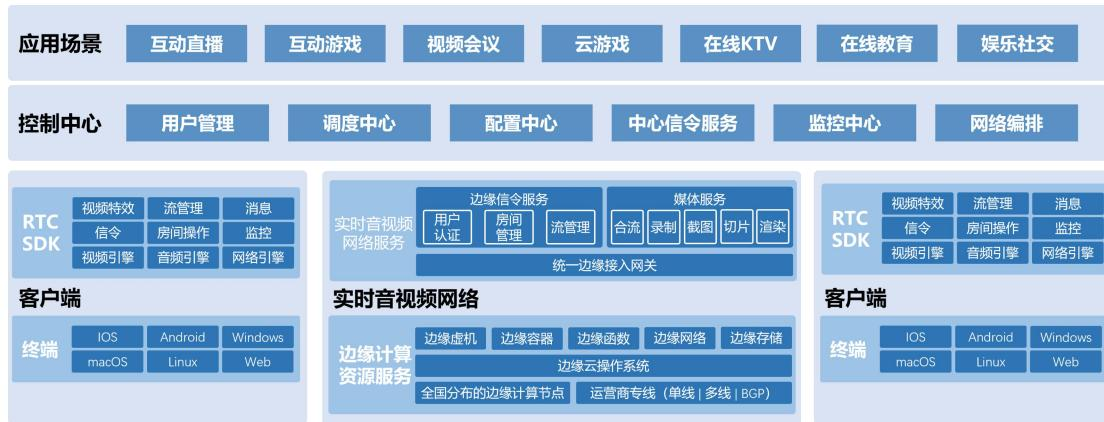
图 11 边缘计算音视频参考架构
