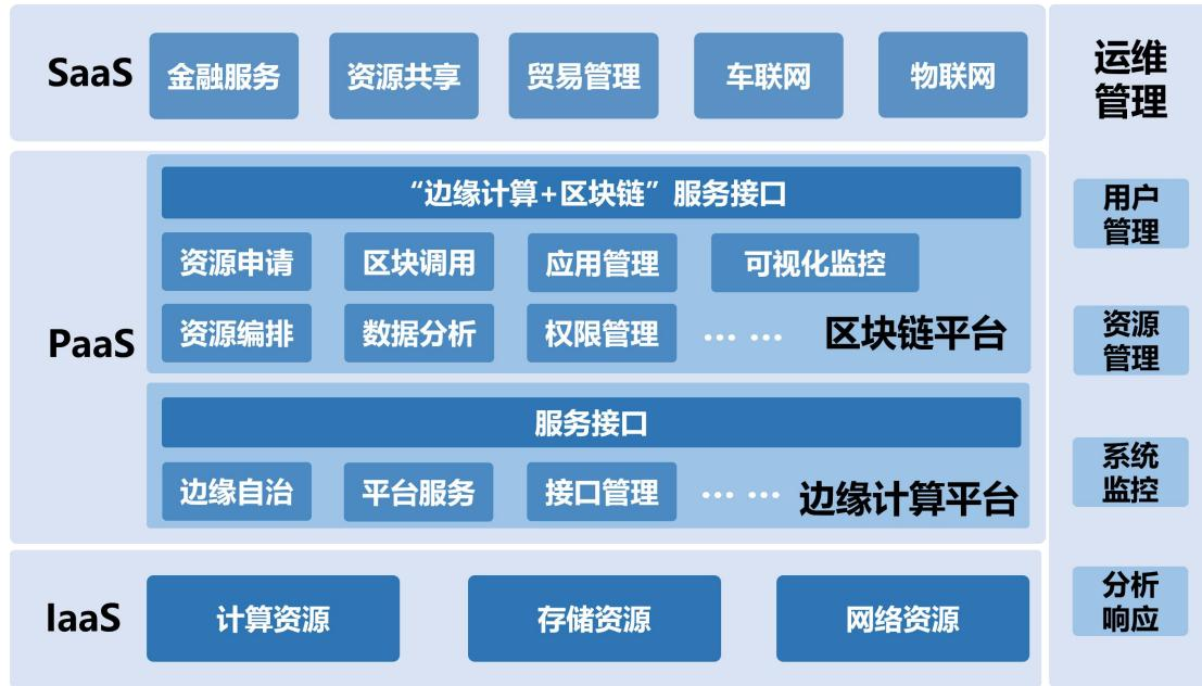
图 16 边缘计算+区块链架构图
