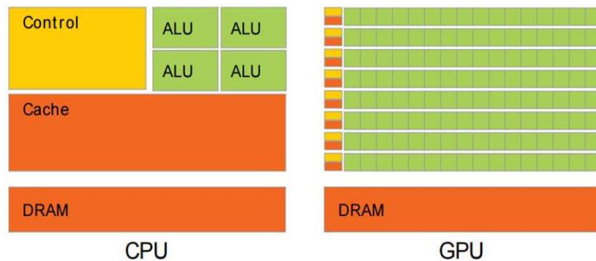
图 17：CPU 与 GPU 架构
