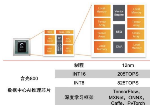
图 42：阿里平头哥 AI 芯片含光 800 架构及参数示意图
