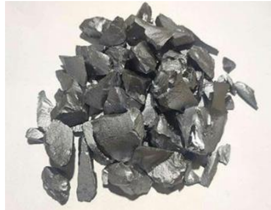
图 11: 改良西门子法生产的棒状硅致密料产品形态
