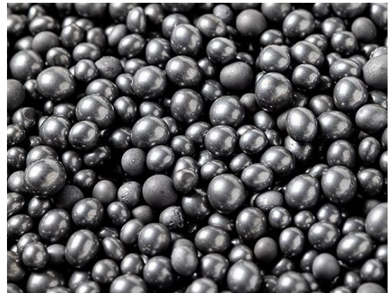
图 13: 硅烷流化床法生产的颗粒硅产品形态
