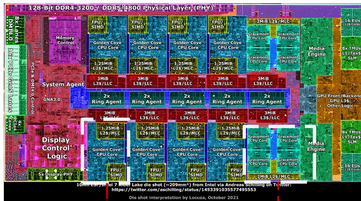
i9-12900K 4个E-core构成一簇总线架构结构示意图
