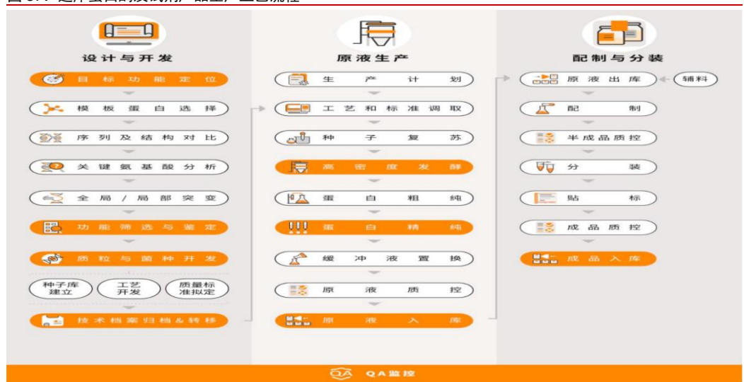
图 37: 近岸蛋白酶及试剂产品生产工艺流程
